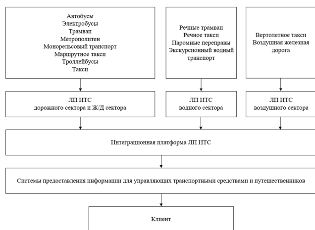
Рис. 5. Модель взаимодействия пользователей системы предоставления информации для управляющих транспортными средствами и путешественников с расширенной интеллектуальной транспортной системой, включающая в себя все виды имеющегося транспорта в локальном проекте ИТС
